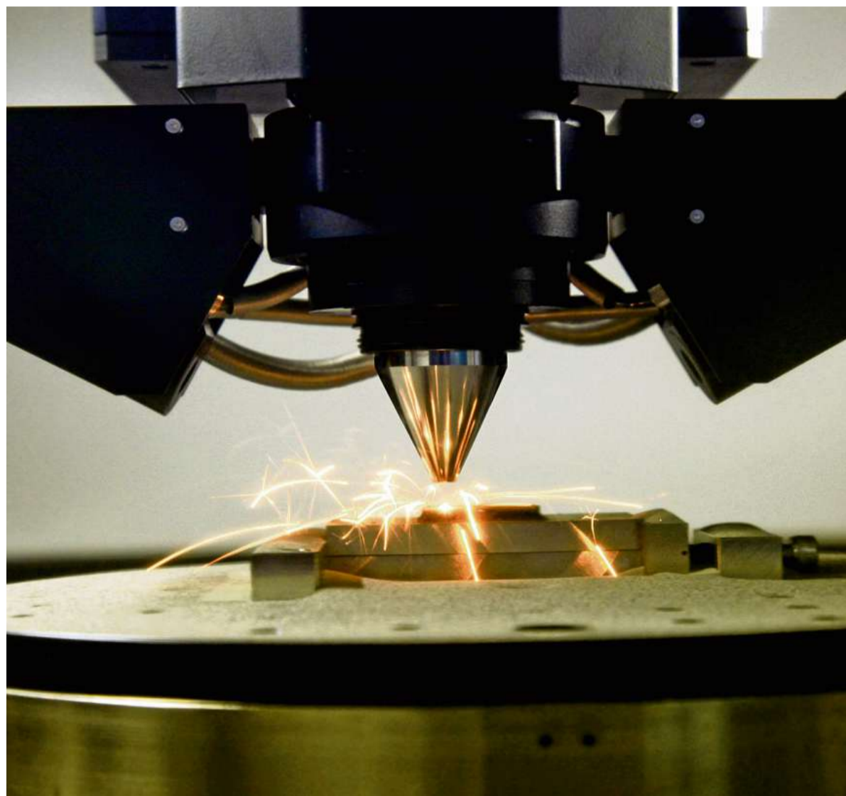
3D-Druck bei Metallanfertigungen ist kein alltägliches Verfahren. Das Attendorner Unternehmen Prototec setzt auf die moderne Technik.
